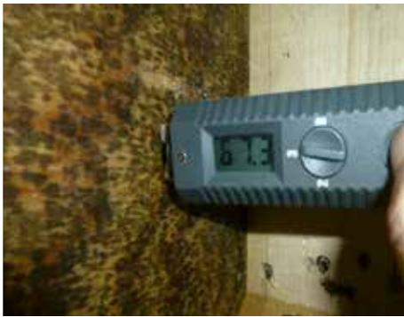
*Pilzbelastung durch hohe Baufeuchte wegen Estrich- und Putzeinbau an der Dachunterseite innen.*
