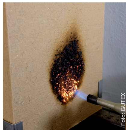
GUTEX Pyroresist ist die erste schwer entflammare und nicht glimmende Holzfaserdämmplatte der Welt!
