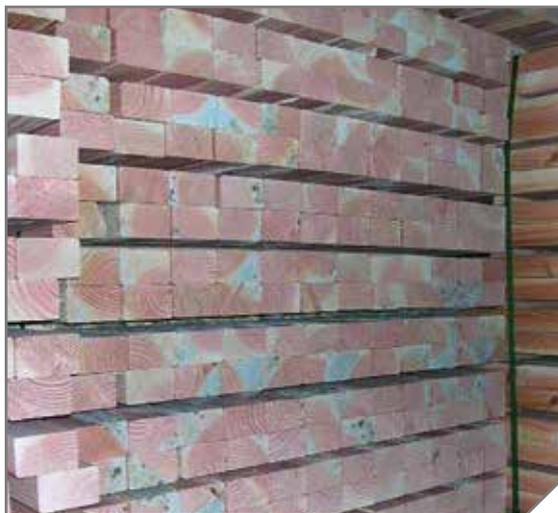
werden blaue bis grau-schwarze Verfärbungen hervorgerufen. Durch Holzrocknung kann einer Verblauung vorgebeugt werden. Die Holzfeuchte sollte unter 20% liegen. Auch Schimmelpilze können zu Verfärbungen führen, sind aber nach Abtrocknung einfach durch Abfegen zu beseitigen. Diese Verfärbungen sind bei Terrassendielen kein Reklamationsgrund.
