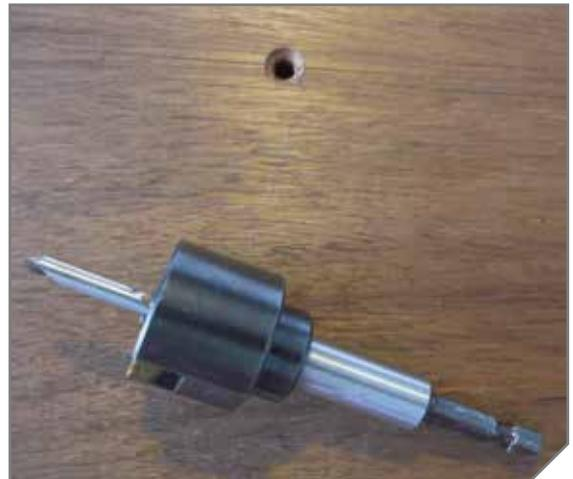
*Spezialbohrer mit eingebautem Versenker ermöglichen eine saubere und gleichmäßige Verschraubung.*
