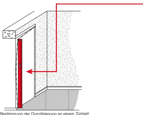
Bestimmung der Durchbiegung an einem Türblatt
