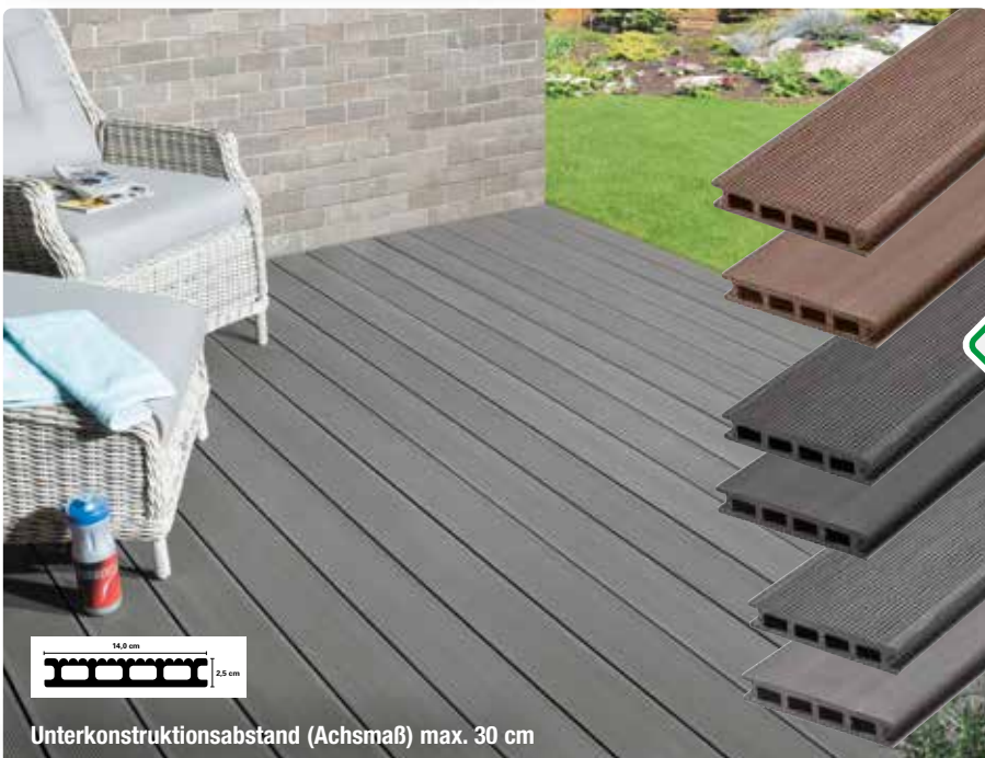
Unterkonstruktionsabstand (Achismaß) max. 30 cm
