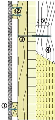
1. Fassadenbekleidung mit Befestigungsmittel
