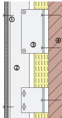
1. Fassadenbekleidung mit Befestigungselement (hier Niete oder Schrauben)
