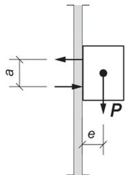
**Abb. 99:** Bei der Konsollast P darf die Exzentrizität e, d. h. der Abstand der vertikalen Wirkungslinie von der Wandoberfläche, nicht größer als 300 mm sein. Der Hebelarm a der entstehenden Horizontalkräfte muss mindestens 300 mm betragen.
