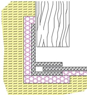
**Abb. 42:** Ein wasserdichter Anschluss ist mit einer zusätzliche Abdichtung unterhalb der Fensterbank realisierbar (siehe H • 6 • g).
