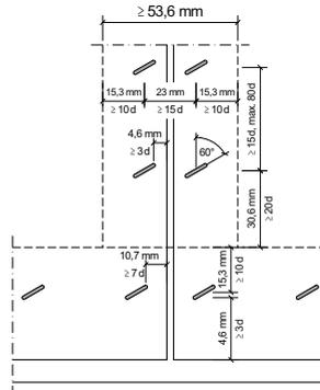
Zu beachten ist, dass der Verarbeiter sicherstellen muss, dass Randabstände eingehalten werden. Dies ist mit reinen Handgeräten schwierig. Eine gute Lösung bieten Geräte mit Führungshilfe. Dies können z. B. Rollenführungen (siehe Abb. 62) oder auch Schienenführungen sein. Eine höhere technische Ausstattung bieten sogenannte »Nagelbrücken« in einer industriellen Fertigungsausstattung.
