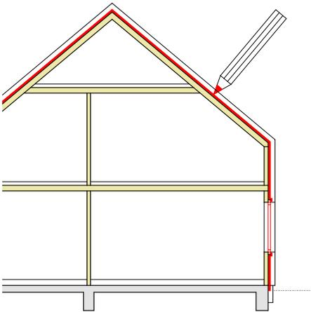
**Abb. 74:** Die Luftdichtungsbahn wird am Übergang zum Steildach in diesem Beispiel auf der Außenseite der Brettsperrholzelemente angeordnet.
