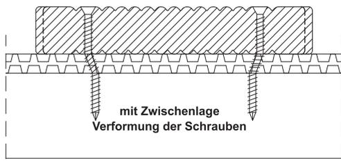
Die Zwischenlage vermeidet den Abriss der Schrauben durch Verformung, sowie eine Kapillarfuge zwischen Unterkonstruktion und Dielenbelag. Eine Aufweichung wird erheblich reduziert.
