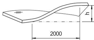
Abb. 109: Längskrümmung in Richtung der Dicke
