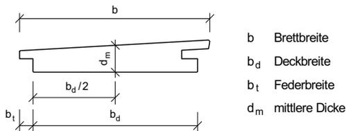
Bei Profilbrett-, Stül- oder Deckelschalungen werden die Bretter zusätzlich zu den Befestigungsmitteln durch andere Fassadenbretter gehalten. Daher ist bei einer Deckbreite bis 120 mm ein Befestigungsmittel je Befestigungspunkt ausreichend (Abb. 46, oben). Ab einer Brettbreite von mehr als 120 mm sind zwei Befestigungen erforderlich (Abb. 46 unten).
