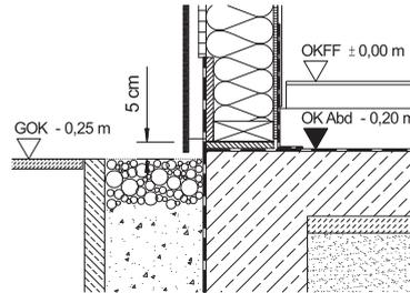
Bitte beachten: das Gelände darf in keinem der drei Fälle höher angefüllt werden. Dies sollte vertraglich mit dem Bauherrn vereinbart werden. Eine Prinzipzeichnung mit den Bauhöhen kann/sollte in den Bauvertrag aufgenommen werden.
