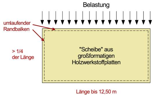
**Abb. 87:** Die Beplankungen laufen immer quer zu den Deckenbalken. Die Querstöße der Platten müssen (!) auf dem Balken liegen. Die Längsstöße haben eine Nut-Feder-Verbindung, eine Verleimung ist nicht erforderlich. Die Balken können im Gebäude längs oder quer gespannt werden.
