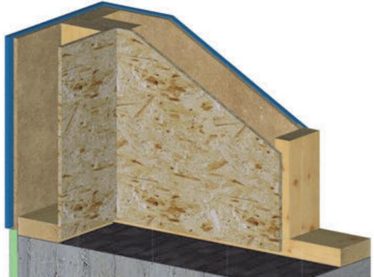
**Abb. 67:** Beim Holzmassivbau ist die massive, tragende Wandschale auf der Außenseite die Hauptdämmebene. Auf der Außenseite wird die Hauptdämmebene montiert. Dies hat viele Vorzüge.
