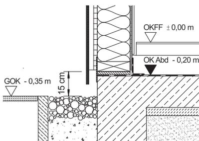
**Abb. 33:** Minimale Sockelhöhe im Holzbau (5 cm). Die Geländeoberkante (GOK) liegt auf  $-0,25$  m. Zum Außenbereich besteht ein Höhenversatz von zwei Stufen. Ein Kiesstreifen (siehe Abb. 32) ist anzuordnen. Zusätzlich ist eine vertikale Abdichtung erforderlich! Diese muss der DIN 18 533 »Abdichtung von erdberührten Bauteilen« entsprechen. Häufig wird als Abdichtungsuntergrund ein Streifen aus zementgebundenen Platten eingesetzt (Freigabe durch den Hersteller erforderlich).
