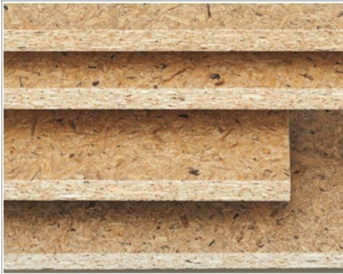
**Techn. Grundlage**®: DIN EN 13 986 mit DIN EN 312 (CE-Kennzeichnung).
