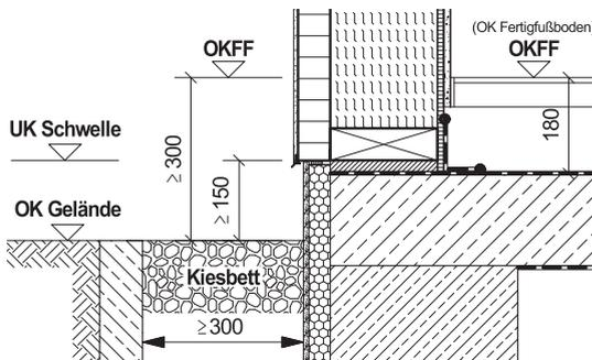
**Abb. 3:** Empfehlung bei hoher Geländeanfüllung (Gebrauchsklasse GK 0 wird eingehalten): Im Bereich der notwendigen Abdichtung wird als Aufkantung ① ein mineralischer Werkstoff verwendet. Die Schwelle ② liegt mind. 150 mm über Gelände, bestehend aus einer Kiesschüttung ③. Die äußere Perimeterdämmung sorgt für eine hinreichende Überdämmung der Abdichtung.
