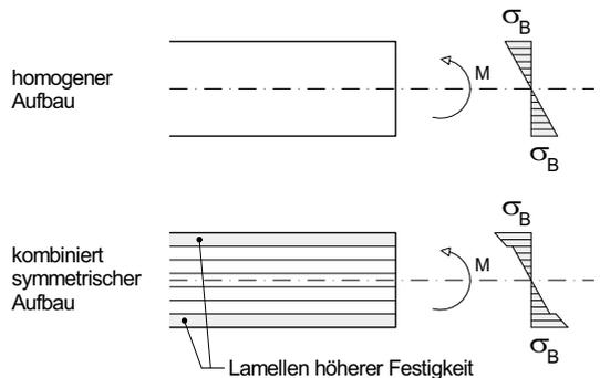
Bei der Tragwerksplanung wird ebenfalls die »Gebrauchstauglichkeit« untersucht. Hier geht es um die Begrenzung der Durchbiegung oder der Schwingung von auf Biegung
