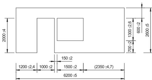
**Abb. 64:** Bestimmung der Rechtwinkligkeit bei einer Wandtafel.
