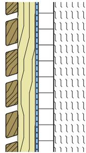
Senkrecht montierte offene Bekleidungen aus Vollholz sind weder in der Fachregel 01 [15] noch in der DIN 68 800 Teil 2 geregelt und sind als Sonderkonstruktionen zu betrachten.
