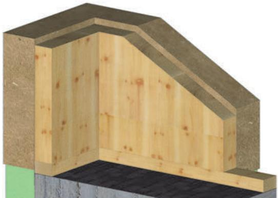
**Abb. 68:** Blick in eine Gebäudeecke bei der verschiedene Bauarten kombiniert wurden (Beispiel). Das Zusammenspiel funktioniert, wenn die Vorteile der verschiedenen Bauarten jeweils ausgenutzt werden. Der Wechsel an der Geschossdecke kann sehr interessant und leistungsfähig sein.
