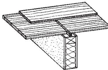
Sinnvoll ist es, die Oberflächenvergütung der sichtbaren Schalung bereits vor dem Einbau vorzunehmen. Maschinell aufgetragene Beschichtungen<sup>®</sup> ergeben eine hochwertigere Oberfläche und werden kostengünstiger ausgeführt. Sichtbare Deckenbalken sollten immer einen Grundanstrich nach dem Abbund erhalten. Leichte Verschmutzungen aus der Montage können dann i. d. R. einfach abgewischt werden.
