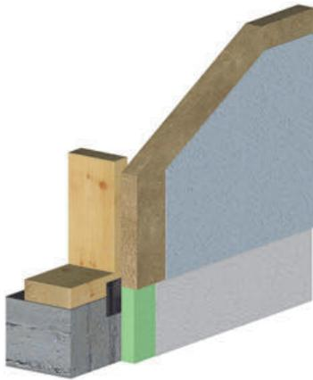
🔗 DIN 68 800-2 stellt im Anhang A einen Wandaufbau mit Wärmedämm-Verbundsystem dar.
