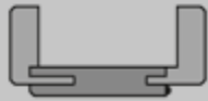
Zarge mit runder Futterplatte und runden Bekleidungen (60 mm), Verstellbereich: Wandstärke >80mm bis 100mm: -5/+15mm Wandstärke >100mm: -10/+10mm
