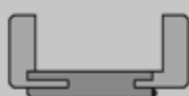
Zarge mit runder Futterplatte und Bekleidungen mit kl. Rundkante (60 mm), Verstellbereich: Wandstärke >80mm bis 100mm: -5/+15mm Wandstärke >100mm: -10/+10mm
