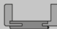
Zarge mit runder Futterplatte und Bekleidungen mit kl. Rundkante (60 mm), Verstellbereich: Wandstärke >80mm bis 100mm: -5/+15mm Wandstärke >100mm: -10/+10mm
