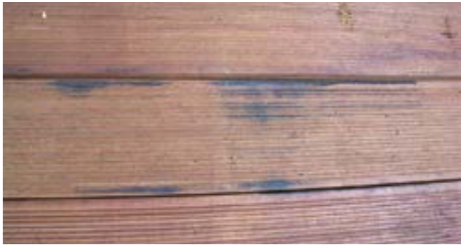
Auf der Unterseite können transport- und lagerbedingte Verschmutzungen vorhanden sein.
