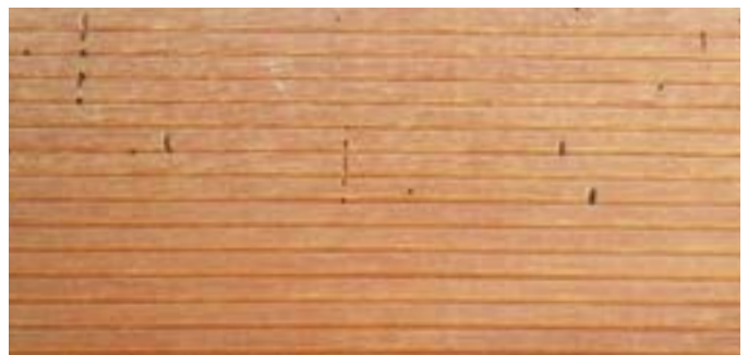
Kleine Löcher durch Insektenfrassgänge sind bei einigen Tropenhölzern normal und nicht vermeidbar.
