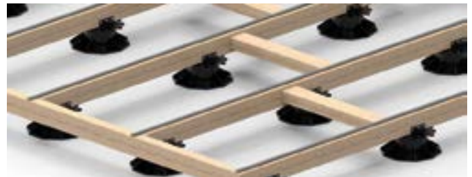
Bei Holzunterkonstruktionen müssen die Verstellfüße immer angeschraubt werden und eine Rahmenkonstruktion sorgt für die notwendige Stabilität.
