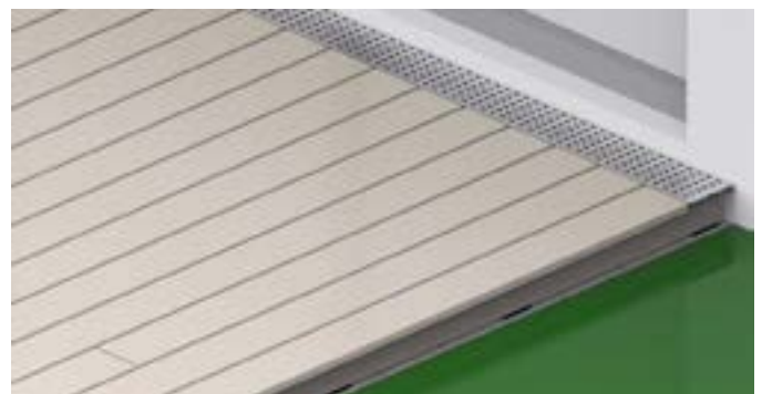
Bild 3. Verlegrichtung mit einem Gefälle von 1-2 % vom Haus weg.
