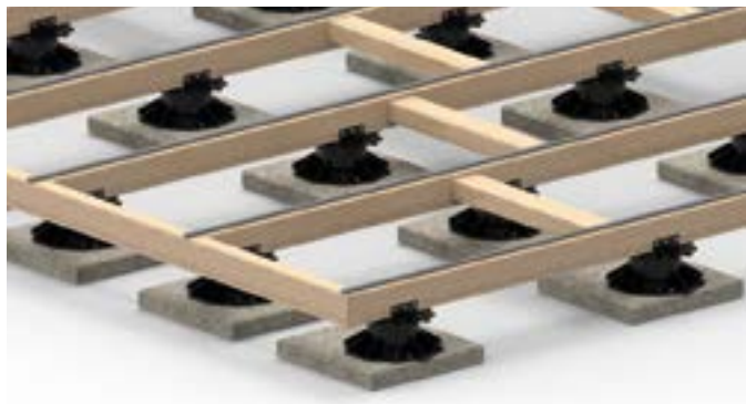
Zur Absicherung der Windlasten müssen z. B. bei Dachterrassen die Verstellfüße an der Unterkonstruktion sowie auf den Betonplatten befestigt werden.
